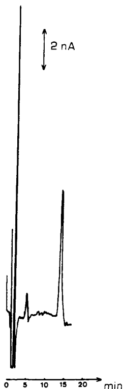
Fig. 3. Dosage de résidus de méthiocarbe sur un échantillon de salade supplémenté à 0,5 mg/kg (injection de 50 \mu l). Potentiel appliqué: +1,00 V/ E_{ref} .
